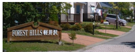
入口のサインと天然ピンコロ舗装
